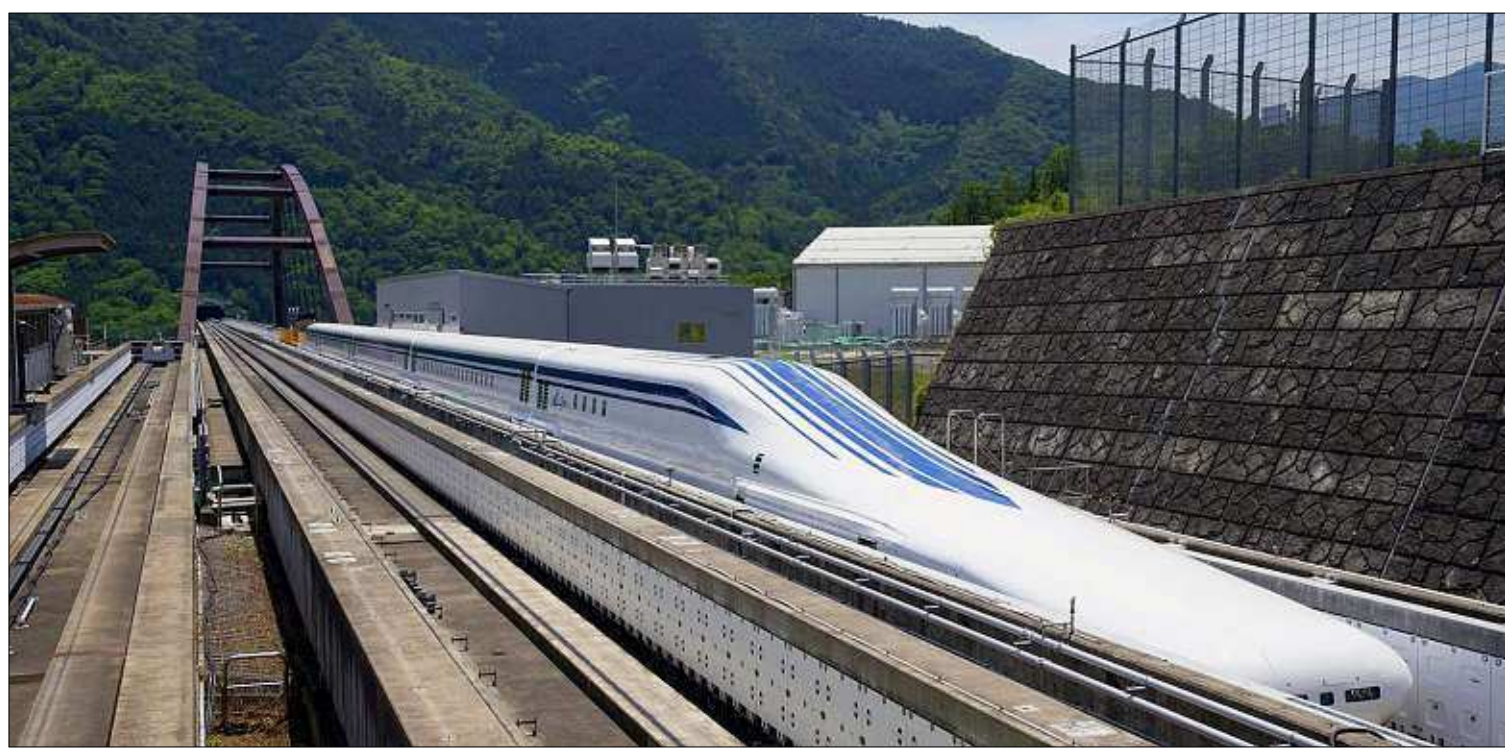
Die neue Magnetschwebebahn der sogenannten L0-Serie wird derzeit getestet. Das futuristische Gefährt verfügt über eine aerodynamische Nase, die mehr als die Hälfte des 28 Meter langen Vorderwagens ausmacht. - Foto: dpa
